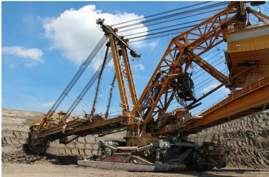
Figure 2 - Retrait du mort-terrain dans une mine de charbon de l'excavateur (Alamy. 2011)
