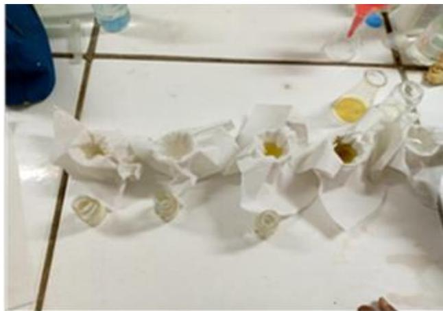
Figure 26 - Filtration des échantillons minéralisés.
