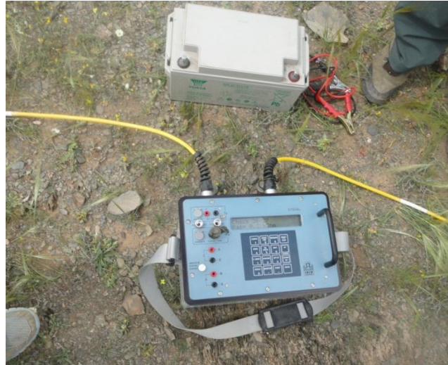
Photo III.6 : Dispositif Syscal Junior Switch-48 utilisé pour les mesures de la tomographie
