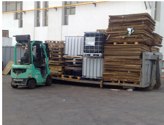
Fig. 38 : chargement d'une benne de 30 m 3 de manière non appropriée.
