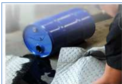
Fig. 11 : Exemple d'application d'un absorbant sur une fuite d'hydrocarbure.
