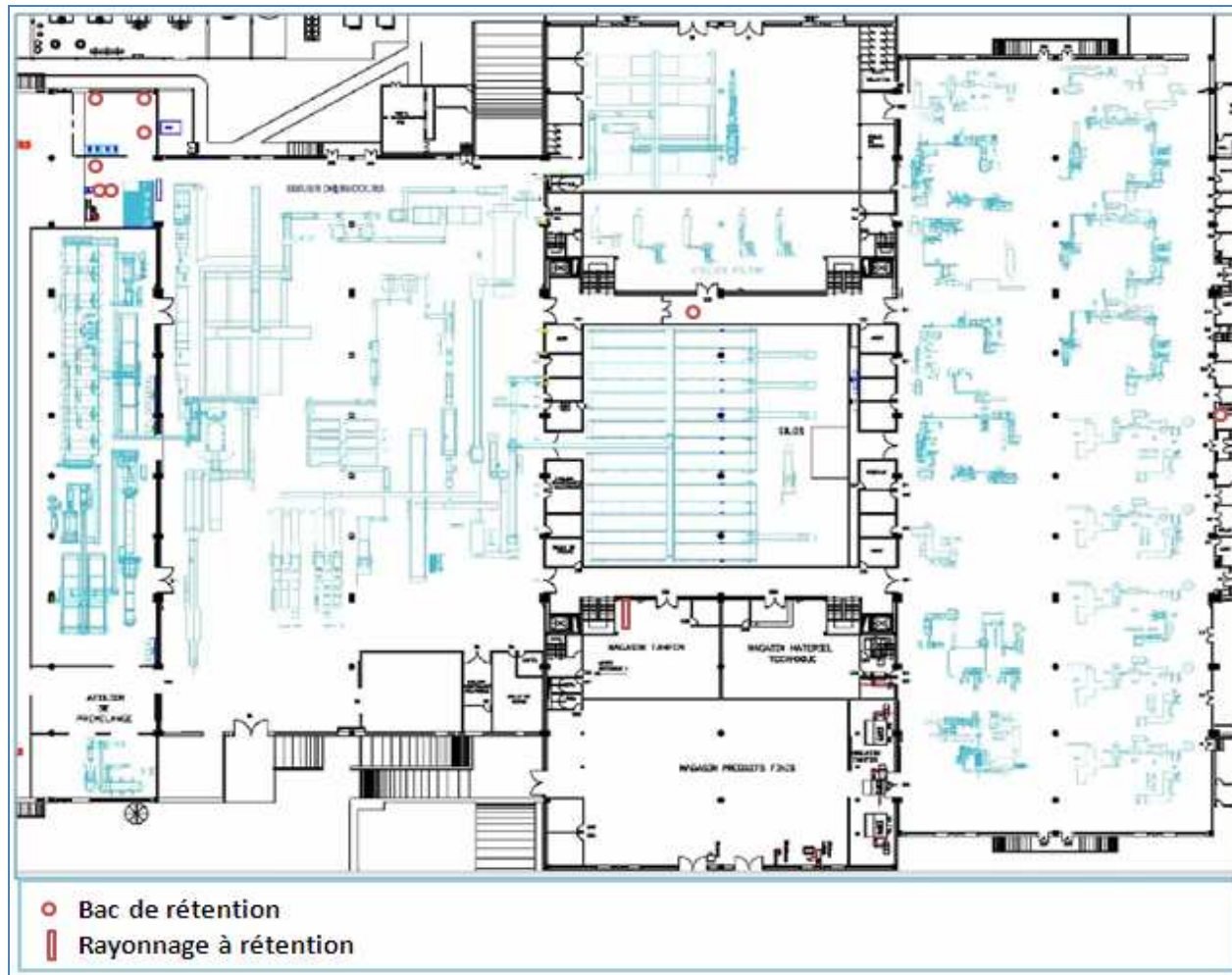
Fig. 54 : Plan bacs de rétentions implantés au sous-sol.
