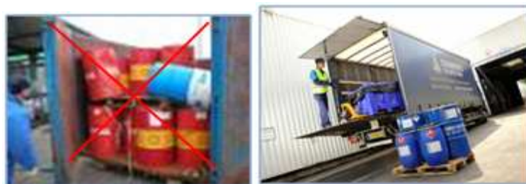
Fig. 52 : Mode de chargement des déchets.
