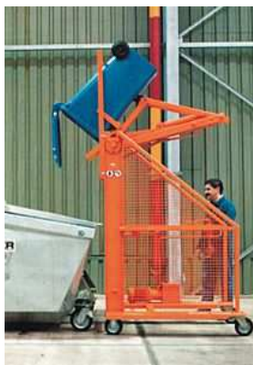
Fig. 48 : Bascule à déchets.
