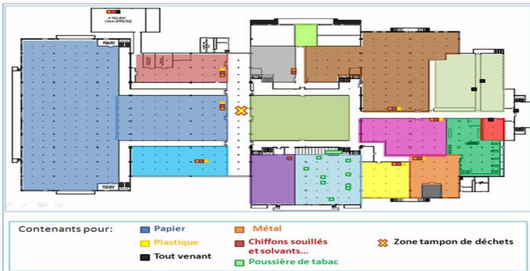
Fig. 34 : Plan benne pour le sous-sol de l'usine.
