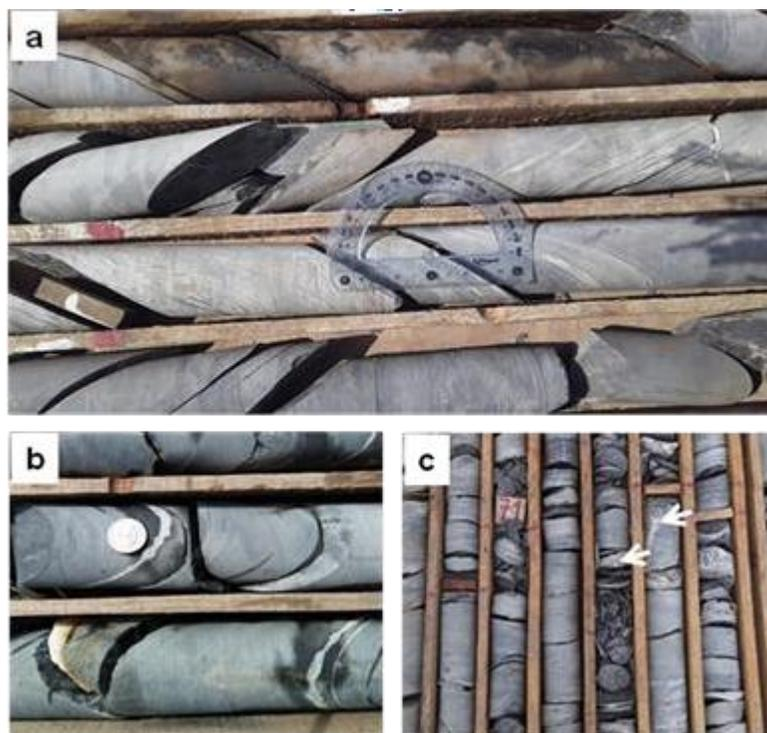
Figure 25: a) pélites noires schistosées riches en matière organique, b) veinule de calcite boudinée, c) Tufs avec des grains grossiers de quartz
