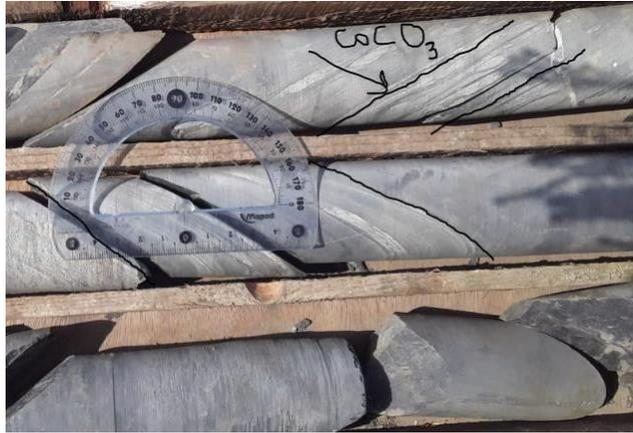
Figure 34: Carbonates suivant la S1
