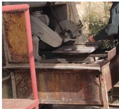
Figure 21: Machine de sciage avec un disque diamanté
