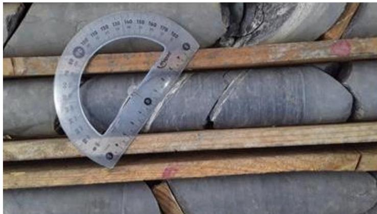
Figure 28: veinule de carbonate parallèle à la S1
