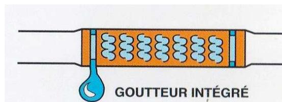
Figure 19 : fonctionnement du procédé du goutte à goutte
