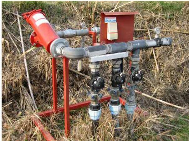
Figure 23 : schéma et photo de filtres à tamis
