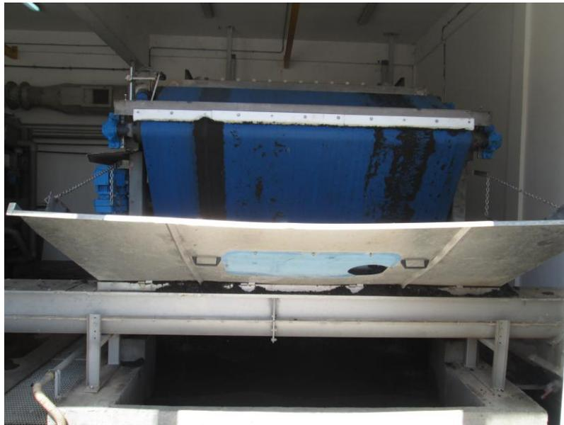
Photo 16 : Mécanisme de déshydratation.
