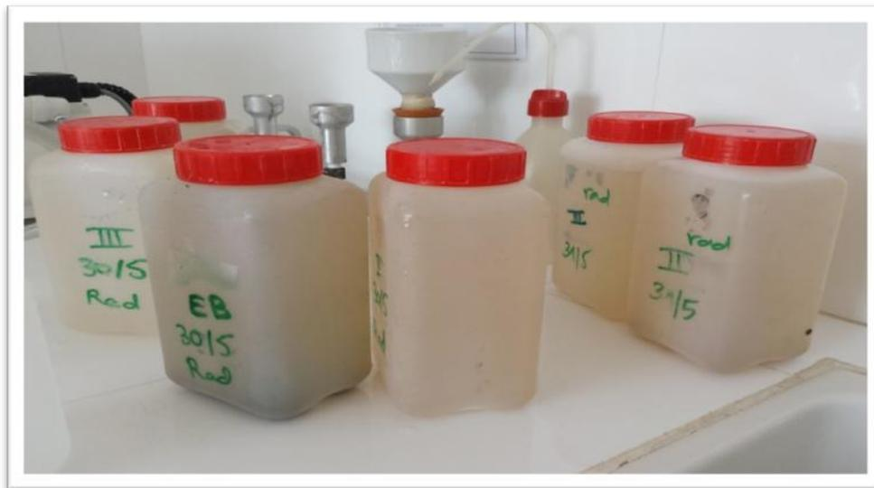
Figure 20 : les prélèvements de chaque étape au niveau de la station d'épuration des eaux usées.
