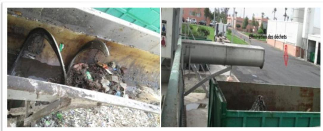
Figure 11 : Dispositif de relevage et d'éjection des déchets
