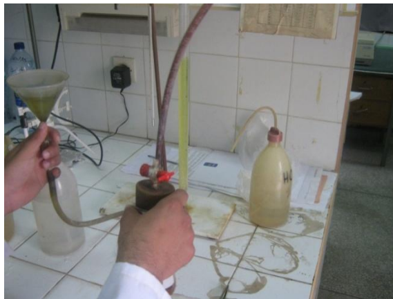
Phot. II. 5 : photographie du calcimètre Bernard utilisé pour le dosage des carbonates.
