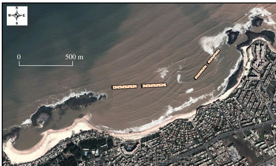
Figure VII. 7 : Positionnement prévu des tubes en géotextile dans la zone d'étude
