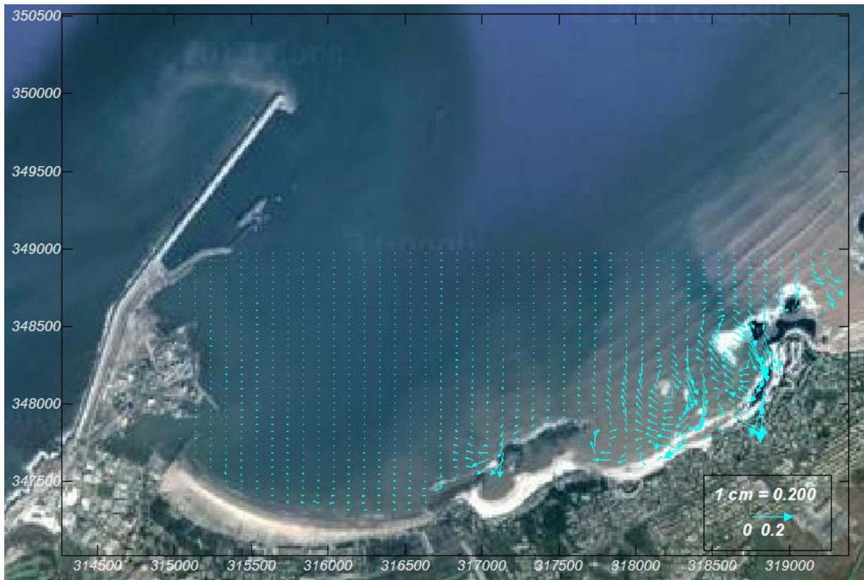
Figure VI. 3 : Direction et intensité des courants après la prolongation de la digue du port
