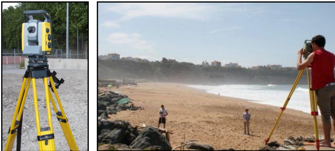
Figure V. 1 : Mesures topographiques sur la plage par le tachéomètre électronique
