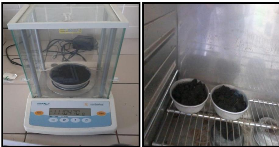
Photo 13: Mesure de la matière sèche des boues déshydratées
