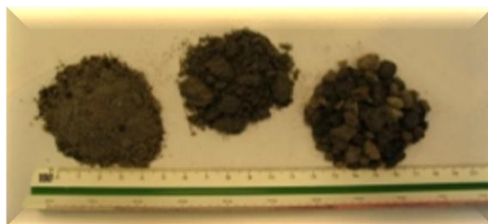
Figure 7 : Morphologie d'une cendre de foyer (NCAB, 2006).
