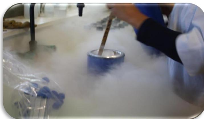
préparation des pièges de la ligne de  $^{14}\text{C}$
