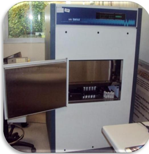
Sous l'action de la particule ionisante, Les molécules du solvant passent de l'état fondamental à l'état excité. En revenant à l'état fondamental, elles réémettent une lumière indétectable. On provoque l'absorption de cette lumière émise par un premier soluté, le PPO, composé fluorescent, généralement appelé **scintillateur**. Il réémet de la lumière à une autre longueur d'onde, plus grande que la première mais encore trop courte pour le détecteur.
