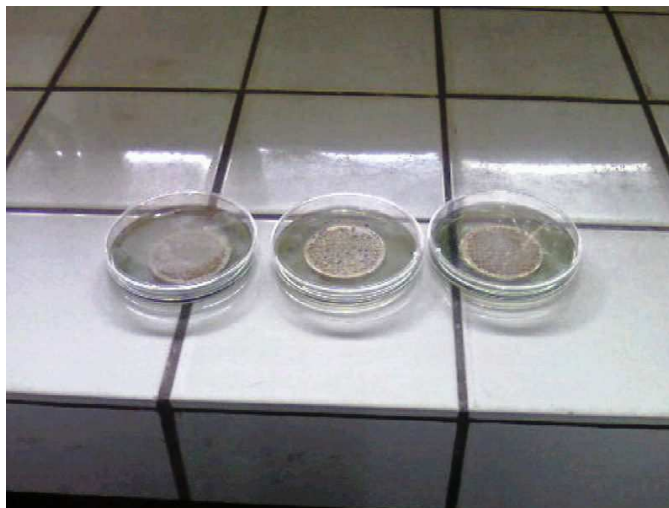
Photo30 : Boîtes de pétri montrant le nombre de bactéries après incubation dans une 100 ml d'eau filtrée
