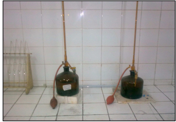
Photo n°15 : Dosage du chlore par le Nitrate d'argent (méthode de Mohr)
