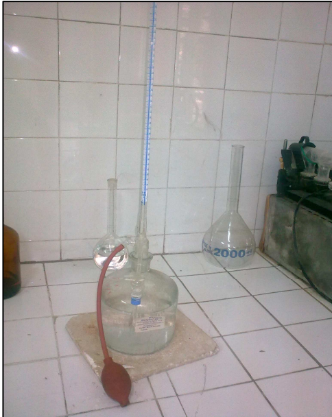
Photo n°16 : Volumétrie par l'EDTA pour déterminer la dureté de l'eau (calcium et magnésium)
