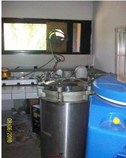
Photo n°24 : Pour stériliser le milieu on utilisé l'autoclave à 121°C durant 15 minutes.
