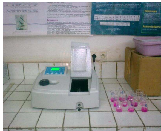
photo n°19 : spectrophotomètre utilisé pour le dosage des Nitrates
