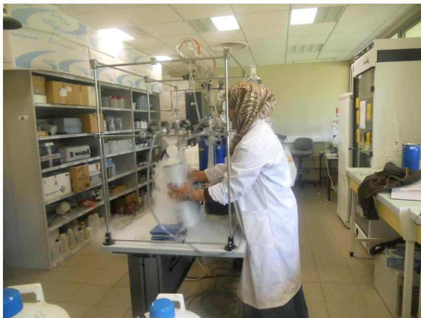
**Figure 6 :** *photo de la ligne de synthèse du benzène au laboratoire d'analyses des isotopes radioactifs*
