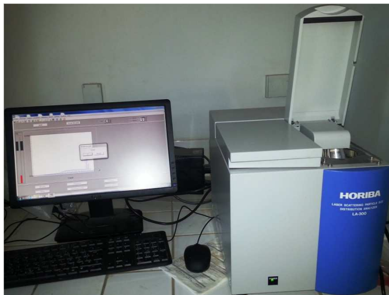
Photo 13 : Machine de granulométrie par diffraction laser (Prise)
