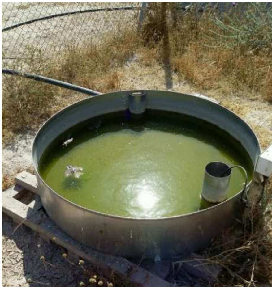
Figure 7 : photo illustrant BAC d'évaporation (Station météorologique de Mzinda).
