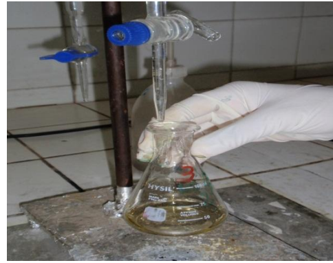
Figure 54: l'ajout de l'indicateur coloré (Bromocrésol).
