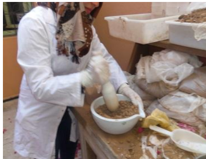
Figure 27: broyage et tamisage des échantillons de sol à 2 mm
