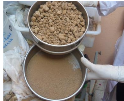
Figure 27: broyage et tamisage des échantillons de sol à 2 mm
