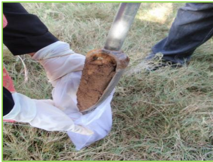
Figure 24: la conservation et le stockage des échantillons de sol.
