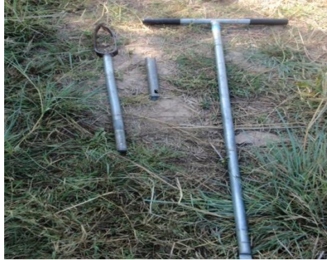
Figure 22: Outil de prélèvement des échantillons de sol-Tarière-
