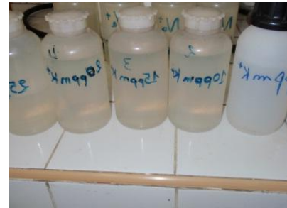
Figure 34: la gamme d'étalonnage (K)
