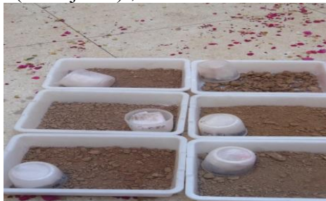
Figure 26: Séchage des échantillons de sol à l'air ambiant
