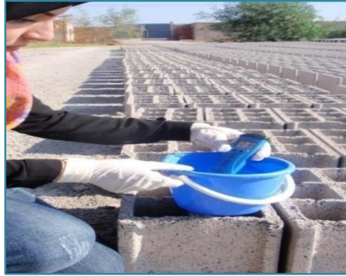
Figure 49: Mesure de la conductivité électrique de l'eau.
