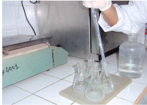
Figure 55: l'ajout des chlorures de baryum.
