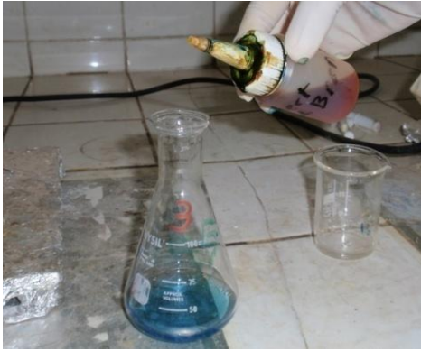
Figure 54: l'ajout de l'indicateur coloré (Bromocrésol).
