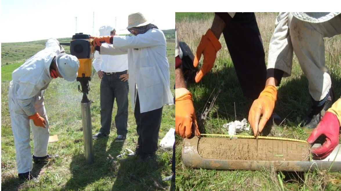
Fig. 12 : Prélèvement à l'aide d'un moteur-carottier.
