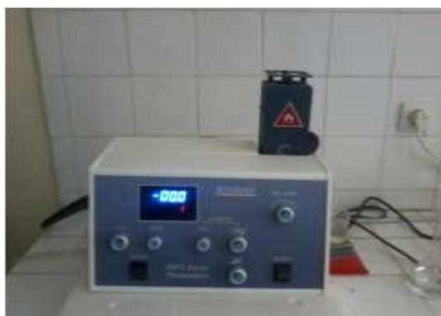
**photo.5 : Spectrophotomètre à flamme.**
