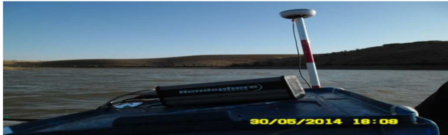
Figure 19 : Hémisphères (ou bien antennes) du système de positionnement
