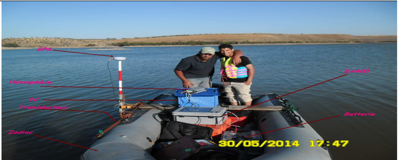
Figure 15 : Equipement sur Zodiac (EA400, Hémisphère, PC, GPS, Batteries)
