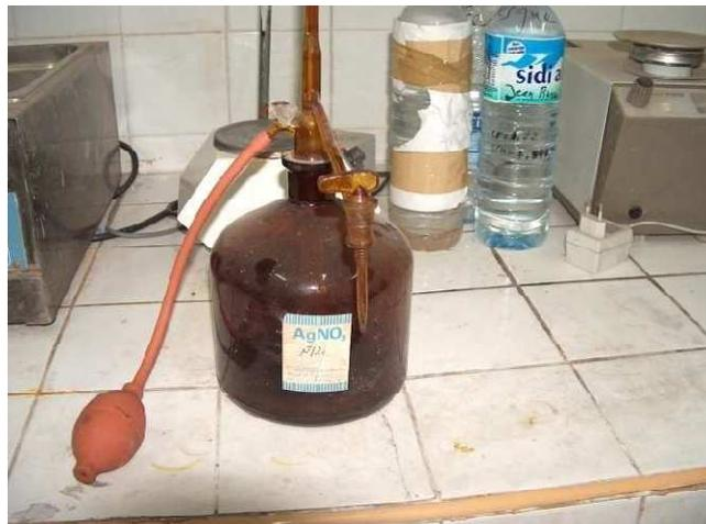
**Photo 2** : Dosage des chlorures (labo du ORMVAH)
