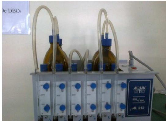
Photos 1: dispositif expérimentale de mesure de la DBO5 au laboratoire
