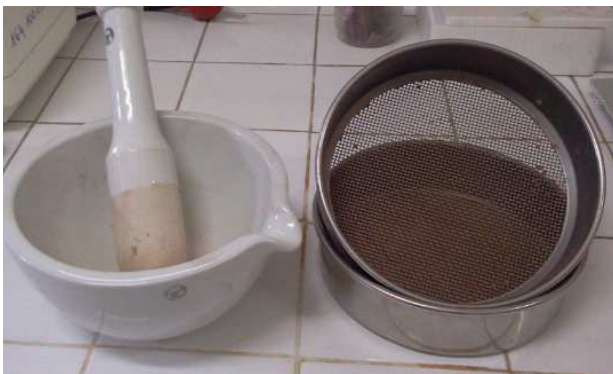
Photo 27 : Avant le tamisage les échantillons de sol ont été broyés à l'aide d'un mortier en porcelaine.
