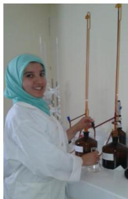
Photo 30 : Titrage par EDTA pour déterminer la dureté calcique
