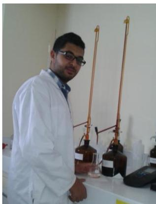
**Photo 29** : Titrage par EDTA pour déterminer la dureté totale.
