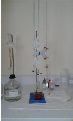
Photo 23 : Titrage par thiosulfate pour déterminer la demande en chlore
