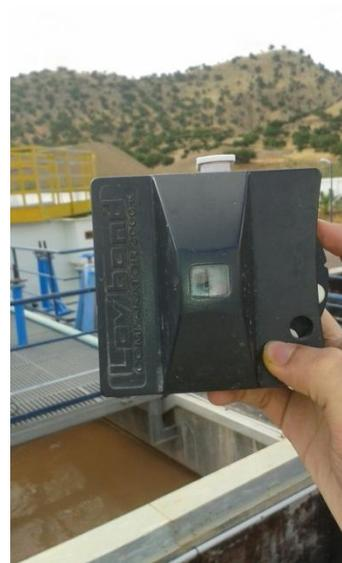
**Photo 21** : Mesure in-situ du chlore résiduel
