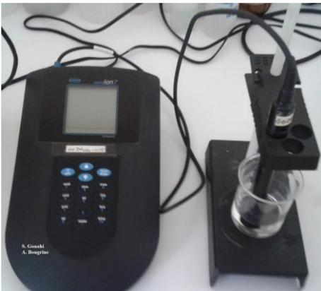
**Figure 18 :** conductivimètre
