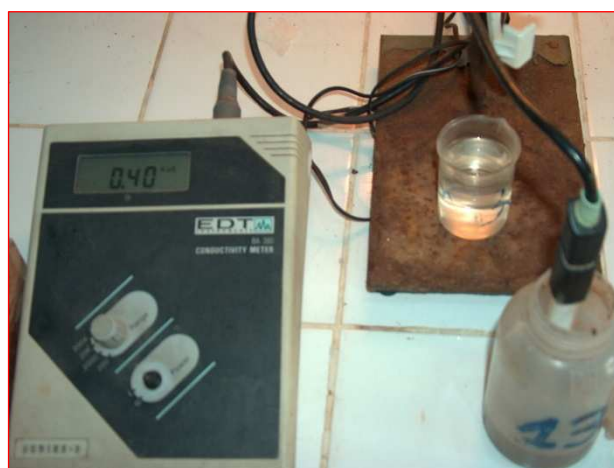
Photo n°1 : Dosage des chlorures (Labo ORMVA du Haouz) Photo n°2 : Mesure de la conductivité de l'eau (Labo ORMVAH)
