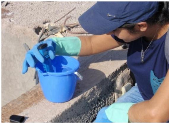
Photo 2 : Mesure de la conductivité sur terrain.
