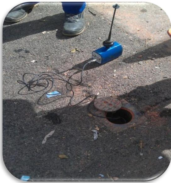
Photo 27: des corrélateurs (transmetteur et l'émetteur)
