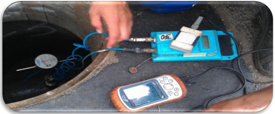
Photo 12: Data-Logger connecté a une PDA.
