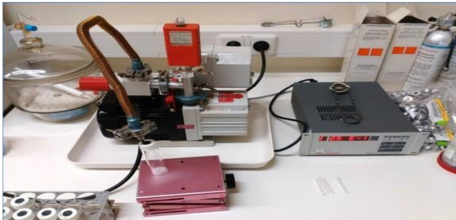
Figure9 : pompe à vide de rotary
