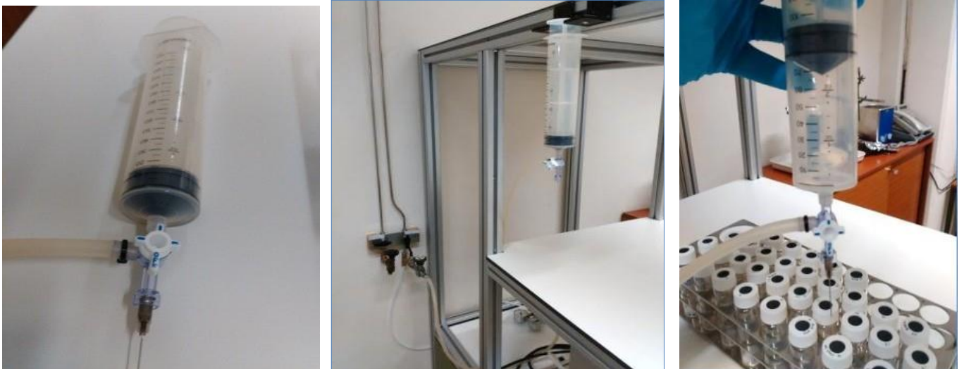
Figure11 : Les étapes d'injection N 2 O
