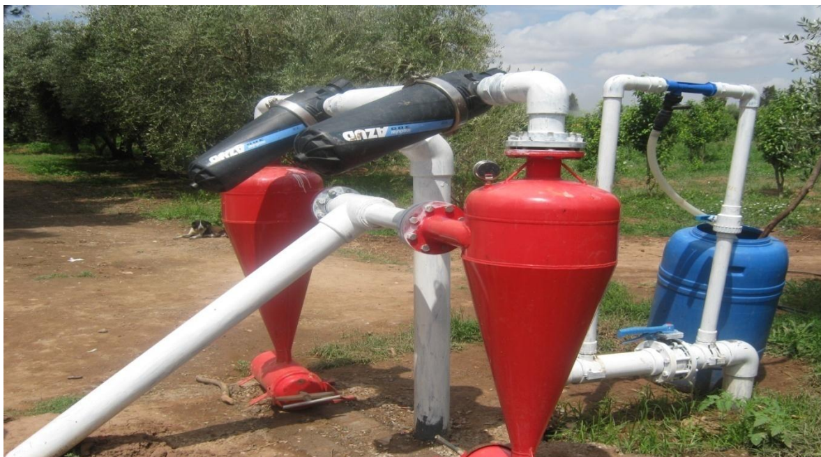
Photo. 7 : Système de filtration (en noir) équipé d'un mélange (en rouge) connecté à un réservoir d'engrais (en bleu) (secteur N1-2).
