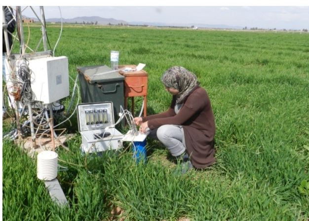
Figure 14 : Dispositif de la collecte de la vapeur atmosphérique (à gauche) et schéma d'installation des tubes d'échantillonnage(T) ainsi que les vaissala(V) (à droite)
