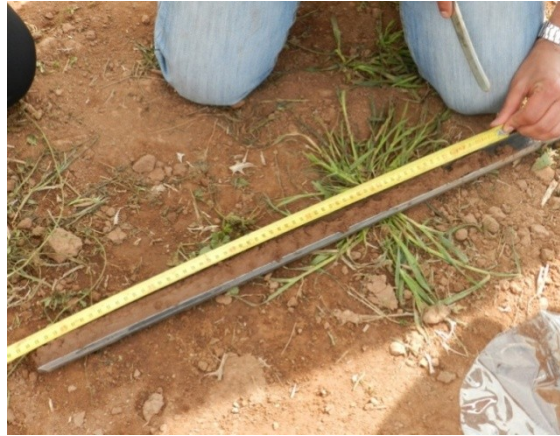
Figure 12 : Le profil du sol prélevé avec la tarière pédologique.
