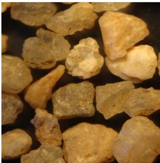
*Figure 27: Photo illustrant la morphologie des grains du sable commercial fin  $\times 20$ .*
