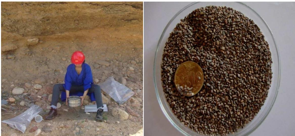
*Figure 8: La photo illustrant la phase de tamisage et l'échantillon de sable obtenu «Cas de Talamount ».*
