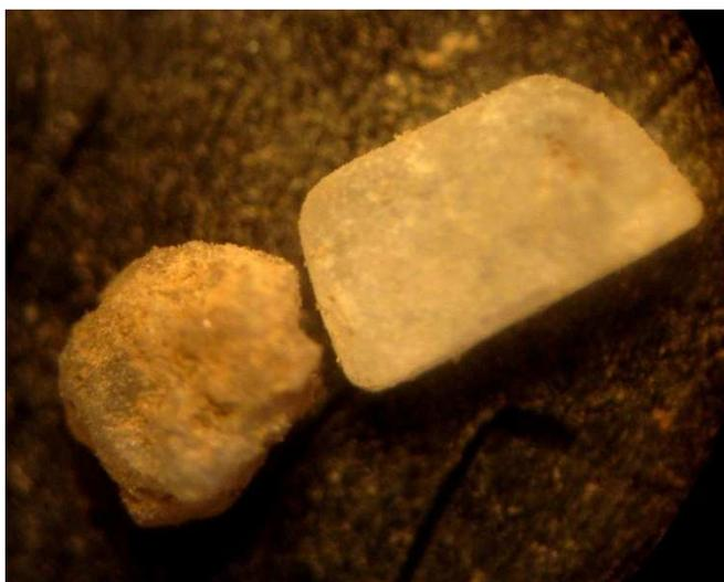
Figure 25 : Photo illustrant la surface polluée d'un grain de sable Talamount  $\times 40$ .
