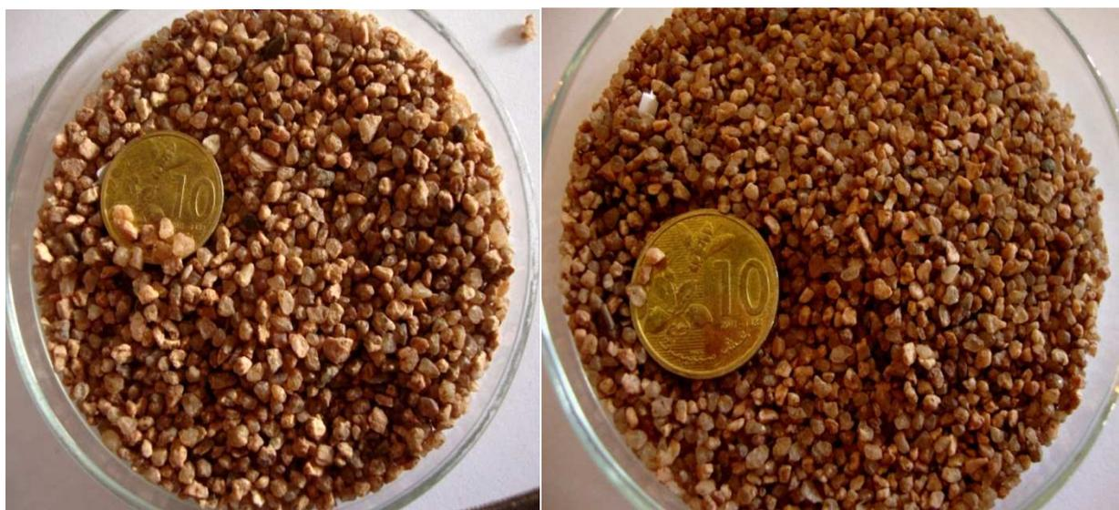
*Figure 13: Photo illustrant des échantillons de sable commerciaux grossier et fin.*
