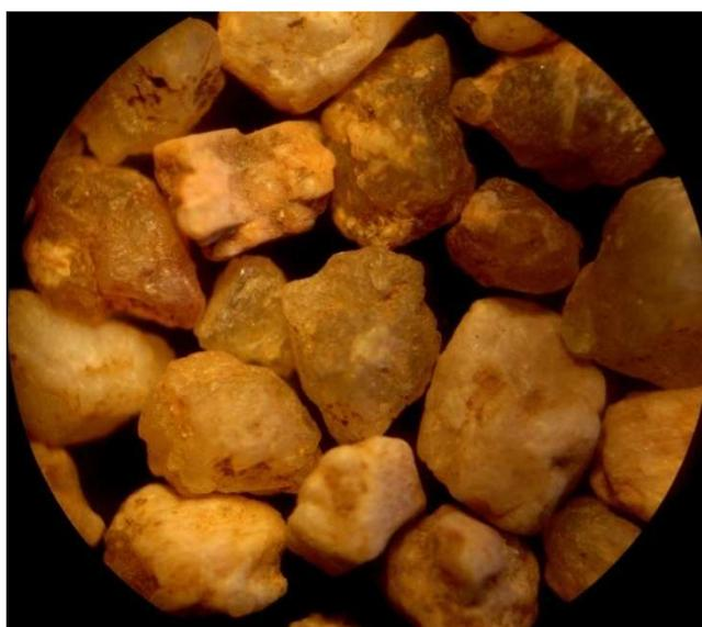
*Figure 28: Photo illustrant la morphologie des grains de sable commercial grossier  $\times 20$ .*
