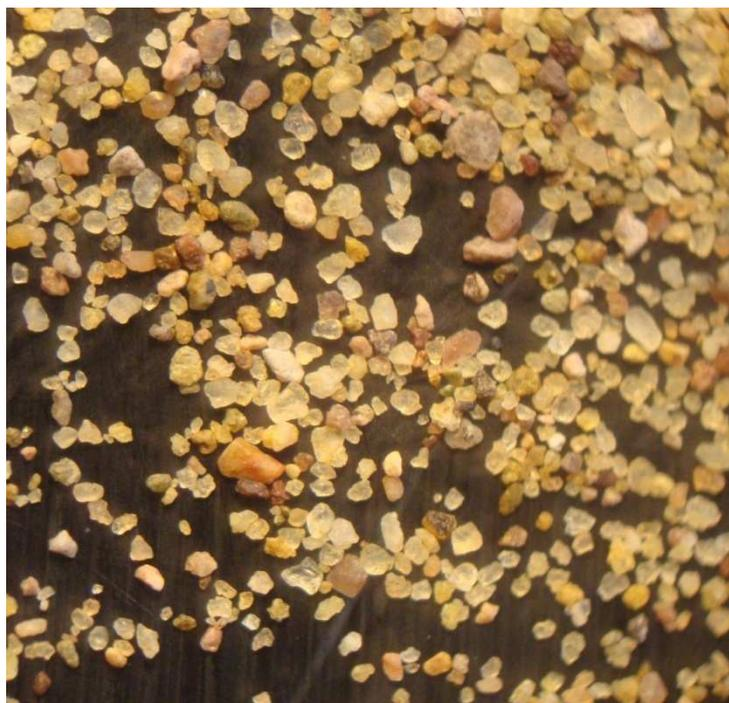
*Figure 26: Photo illustrant la morphologie des grains du sable Oum Jrane × 40.*
