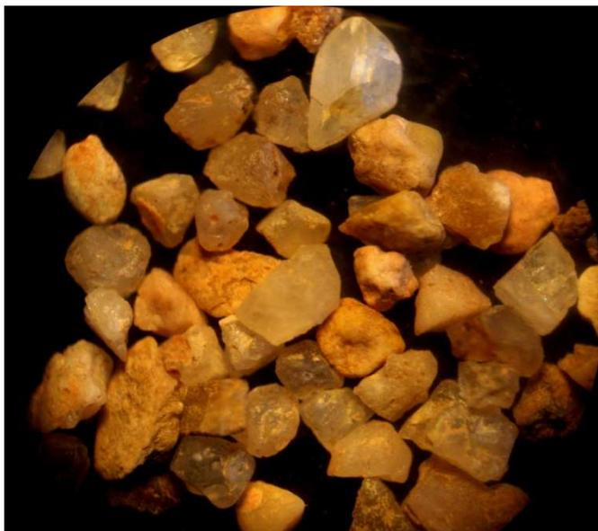
Figure 24: Photo illustrant la morphologie des grains du sable Talamount  $\times 20$ .
