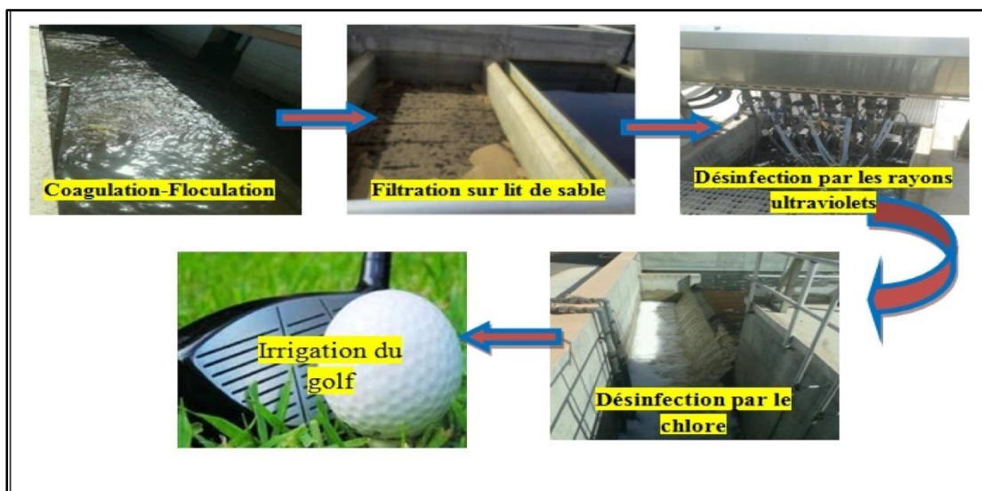
Figure 3 : Déroulement du traitement tertiaire
