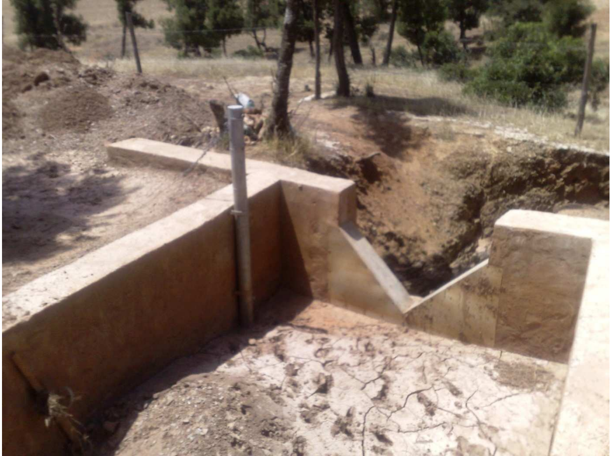
photo 3 : dispositif de mesure (V-Notch) installé dans le micro bassin Sidi Sbea
