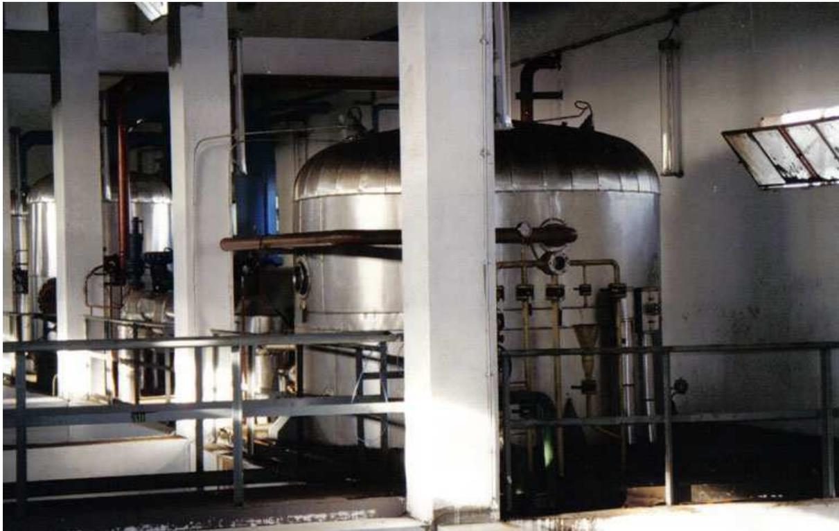
**Fig. 4 : Photo montrant l'installation de dégommage à l'eau (Logan, 2003).**
