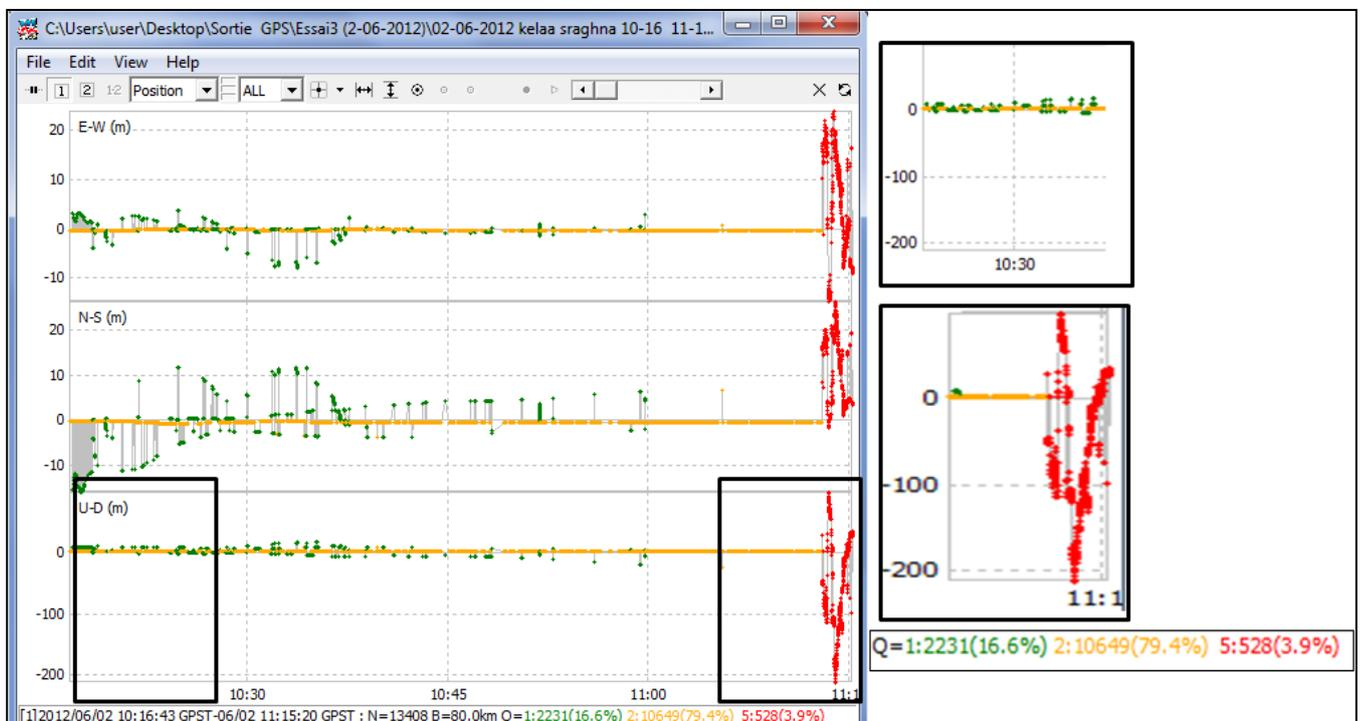
**Figure 42:** La variation des résultats obtenus par RTKPOST dans le temps (abscisses) en fonction de la position horizontale et verticale (ordonnées).
