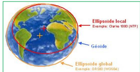
**Figure 1 :** la relation entre le Géôïde, ellipsoïde local et ellipsoïde global
