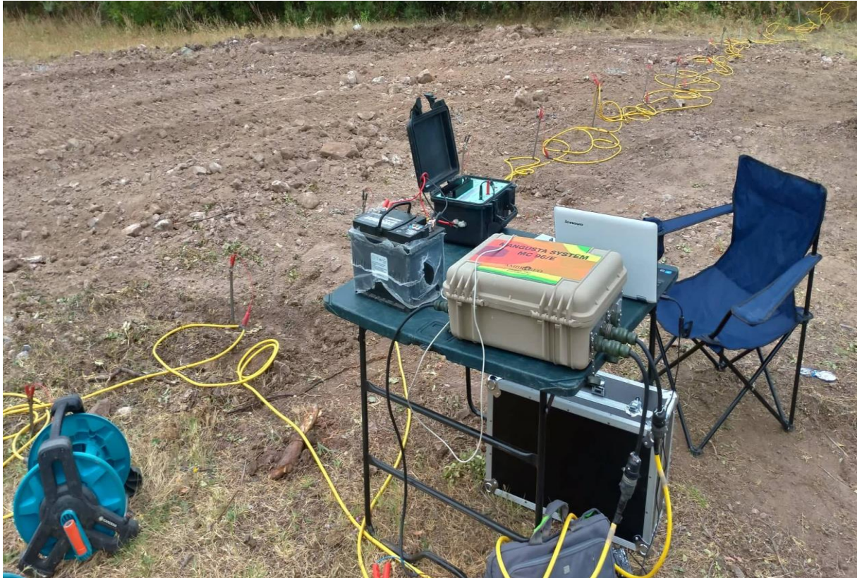
Figure III.2. Système Mangusta MC 96 utilisé pour la mise en œuvre du levé ERT au niveau du site de Sidi Bouzid.
