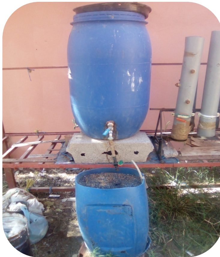
Fig. 10 : Pilote des filtre imbriqué installé au CNEREE
