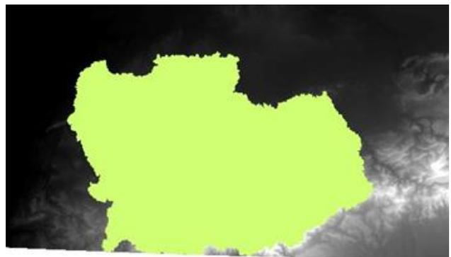
7. La commande « **Clip** » permet de découper le réseau hydrographique sur la limite finale du bassin versant.
