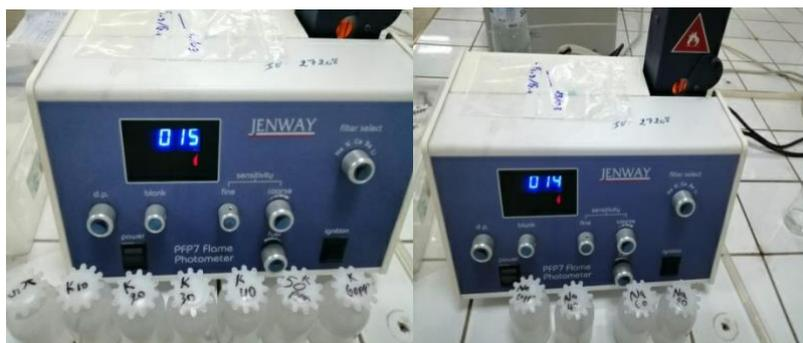
Figure 25 : Spectrophotomètre à flamme
