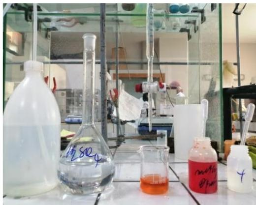
Figure 21 : les réactifs pour la méthode de titration Des carbonates et des bicarbonates
