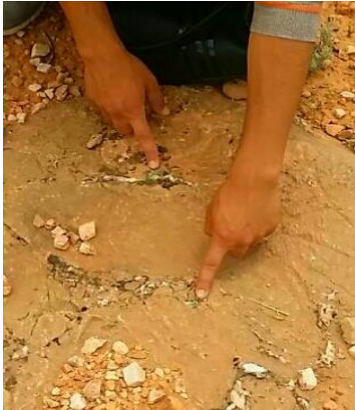
Photo 6: La minéralisation de cuivre disséminé dans des fissures.
