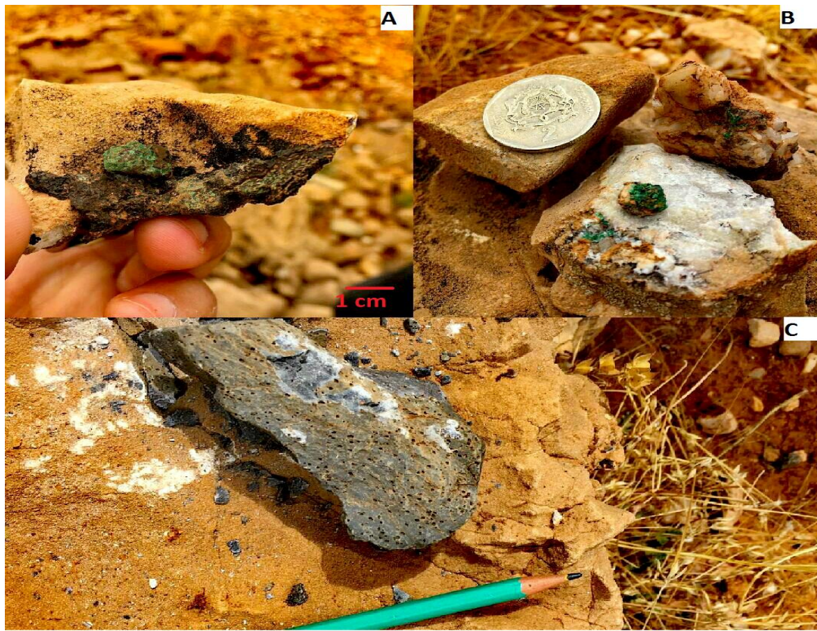
Photo 5 : photo A+B : des échantillons de malachite, phot C : tuf avec des vacuoles.
