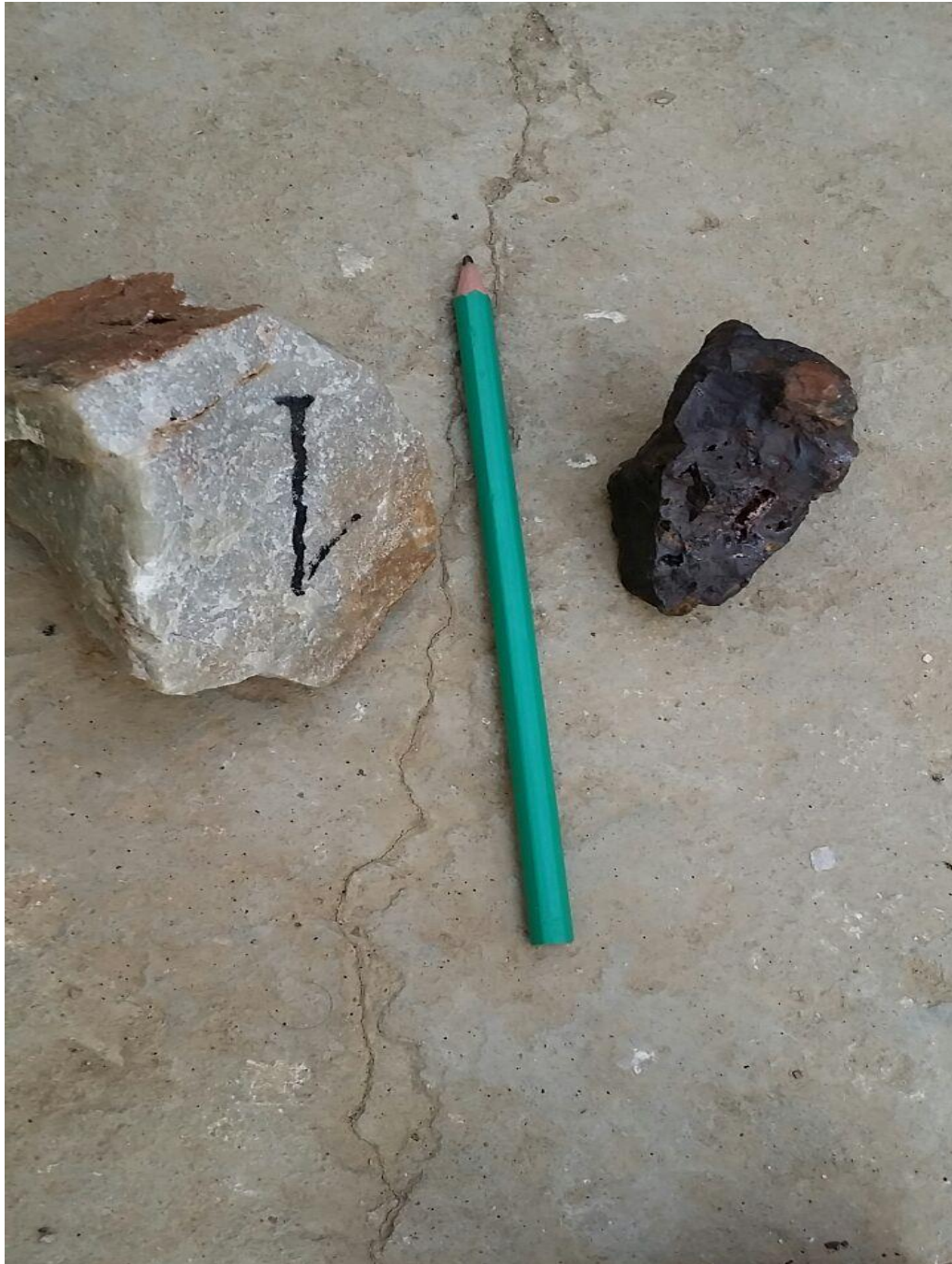
Photo 11 : l'échantillon de droite correspond à une hématite (indicateur de chapeau de fer) et celui de gauche correspond à une dolomie
