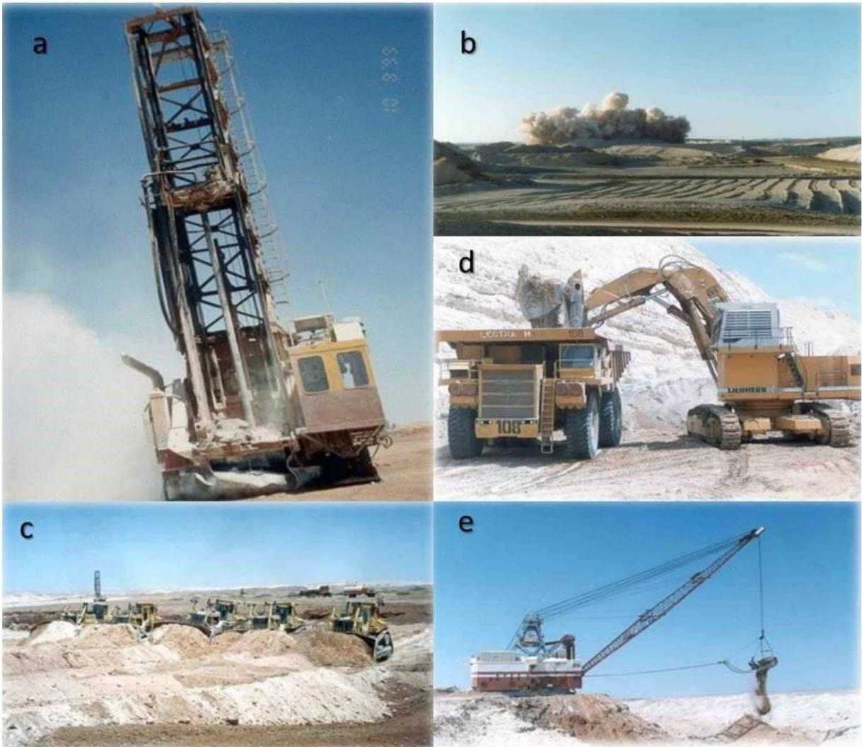
**Figure 10: (a) sondeuse pour la foration des trous, (b) opération de sautage par des explosifs, (c) opération de décapage par bulls, (d) défruitage par chargeuse, (e) décapage par dragline**
