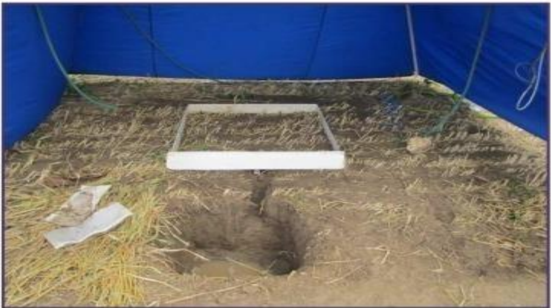
Figure 8 : Simulation des pluies sur parcelle de 1m 2
