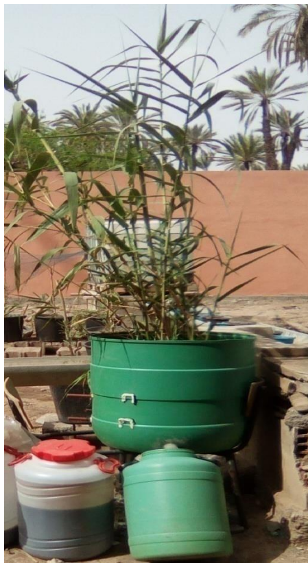
Figure 9: filtre planté installé à la faculté des sciences Semlalia par le LHEA.
