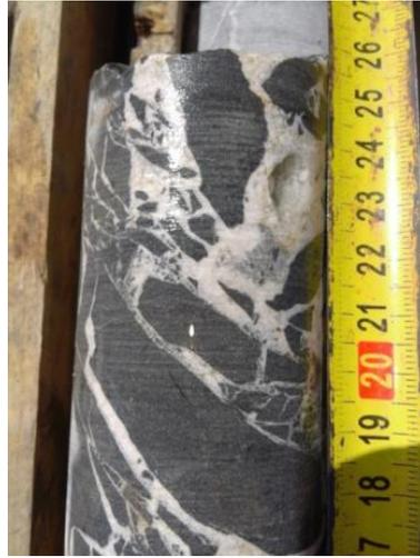
*Figure 17 : Carotte d'une brèche hydrothermale*
