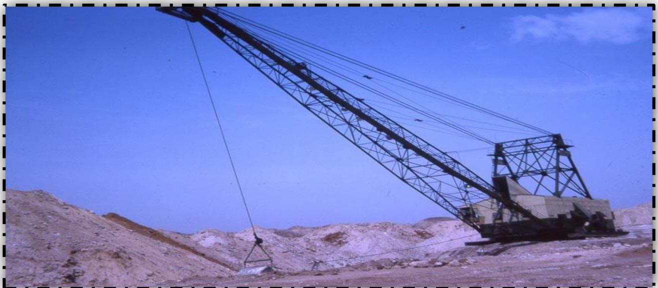
**Figure 10** : Opération de décapage
