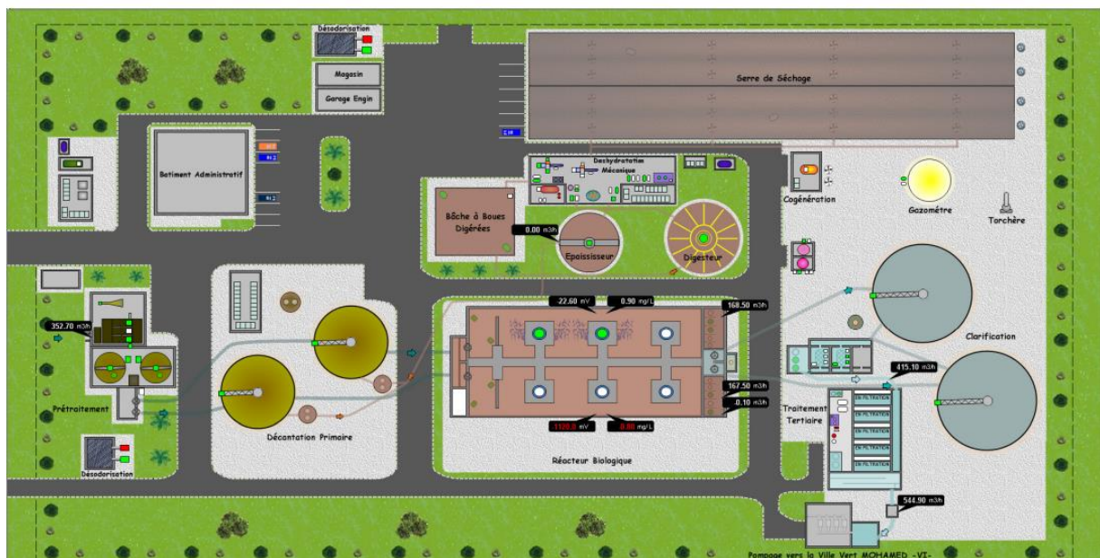
figure 1 : SCHEMA DESCRIPTIF DE LA STEP DE BENGURIR
