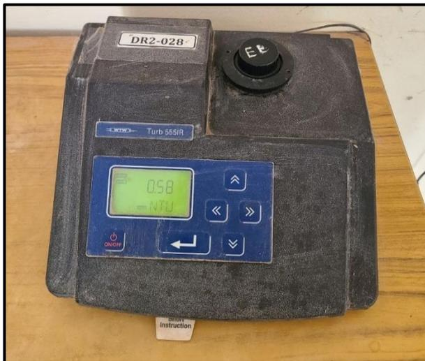
*Figure 17 : Turbidimètre utilisée*
