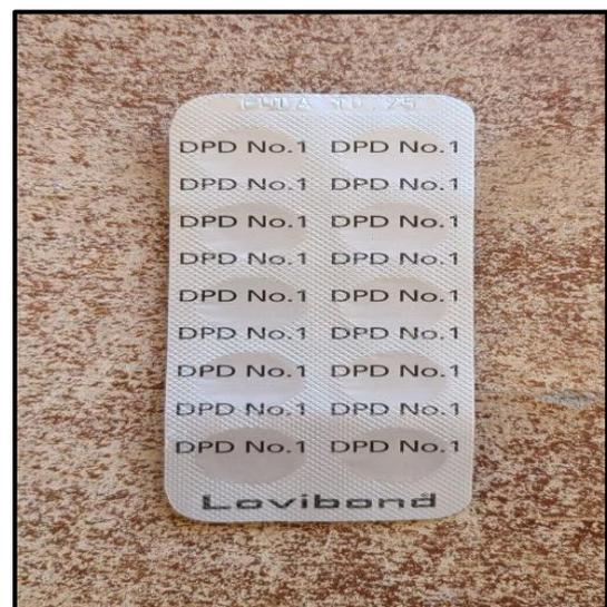
*Figure 20 : Comprimés de chlore DPD*
