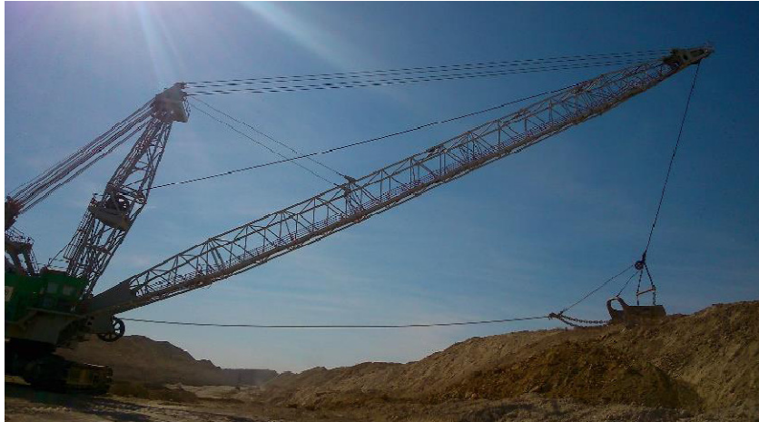
Figure 19 : photographie d'une dragline.
