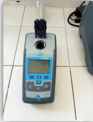
*Figure 24: Turbidimètre*
