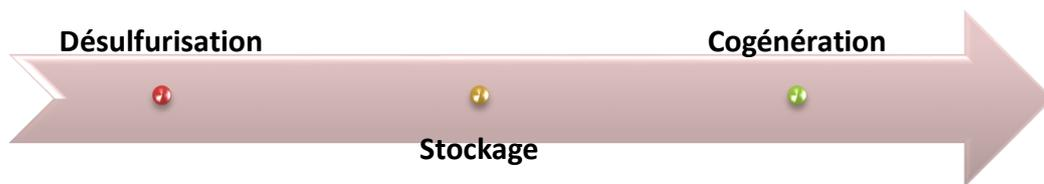
*Figure 19: Les étapes du traitement du biogaz*
