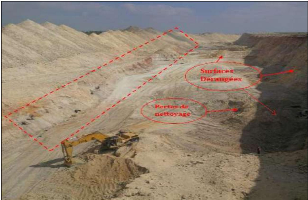
*Fig. 40 : Pertes résultant lors de nettoyage de surface dérangée*
