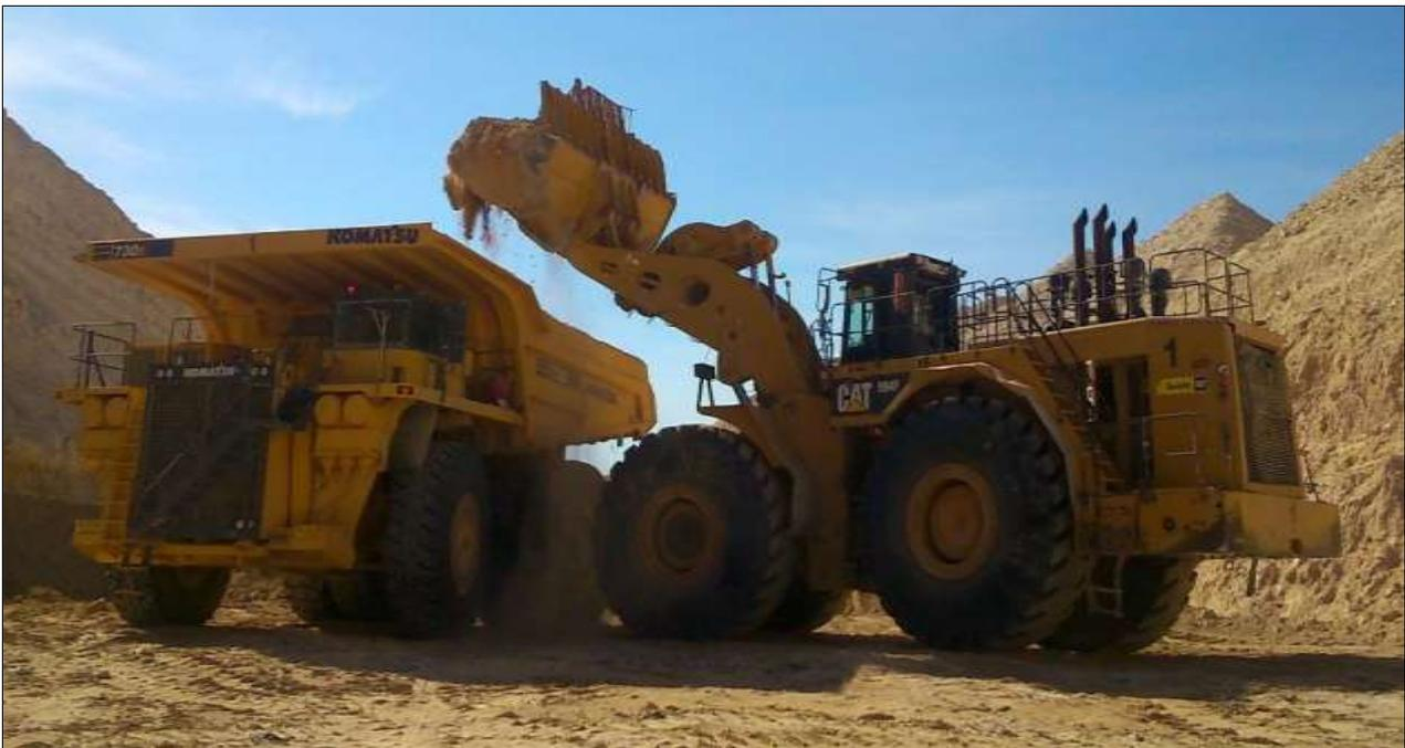
*Fig. 11 : Phase de défruitage. Capacité du camion 136 t, capacité du godet de chargeuse 35 t*
