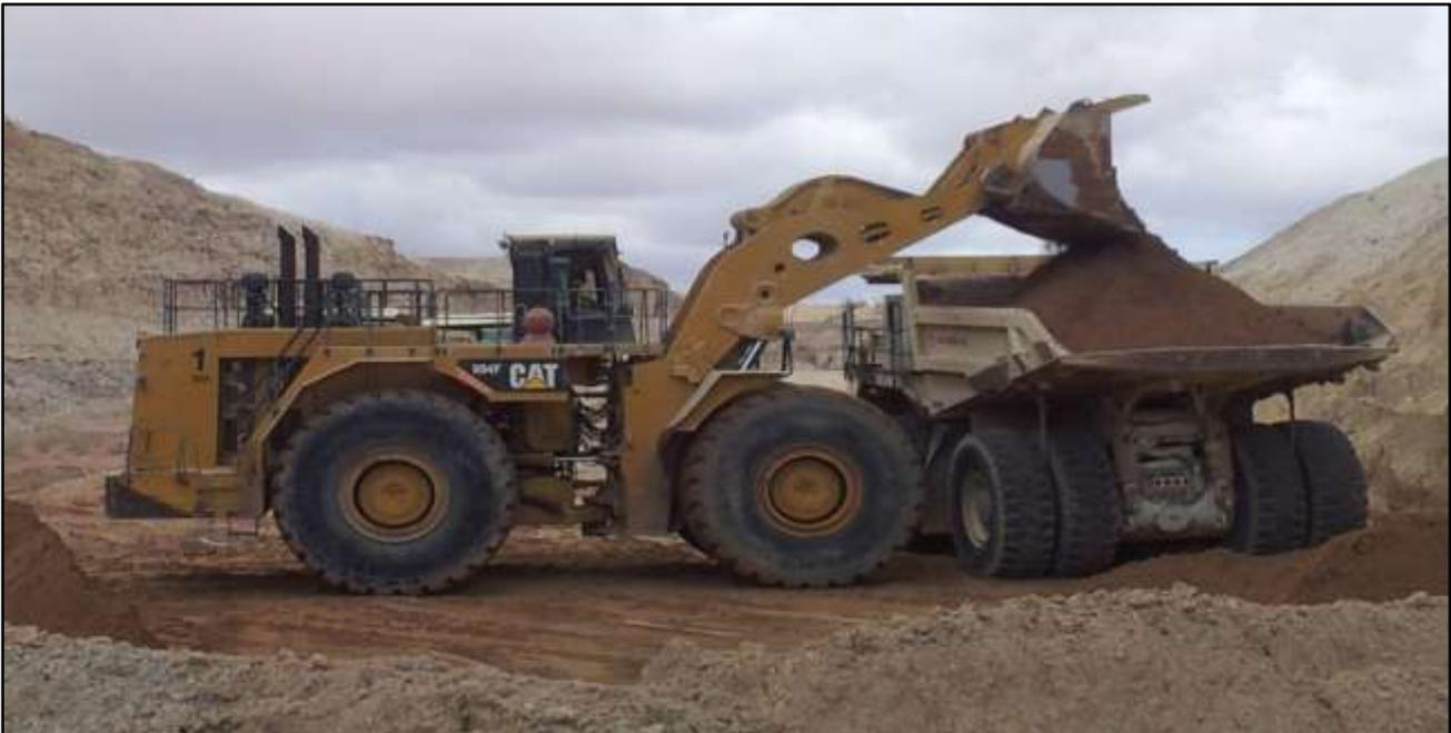
*Fig. 13 : Chargement par chargeuse (capacité du godet 35 t)*
