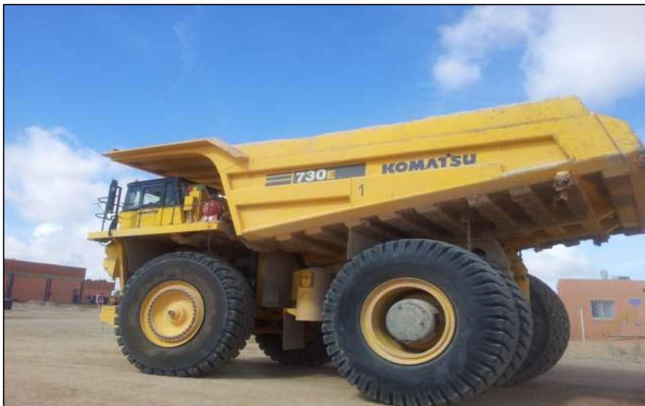
*Fig. 16 : Camion de type KOMAT'SU 730E (capacité 170 t)*
