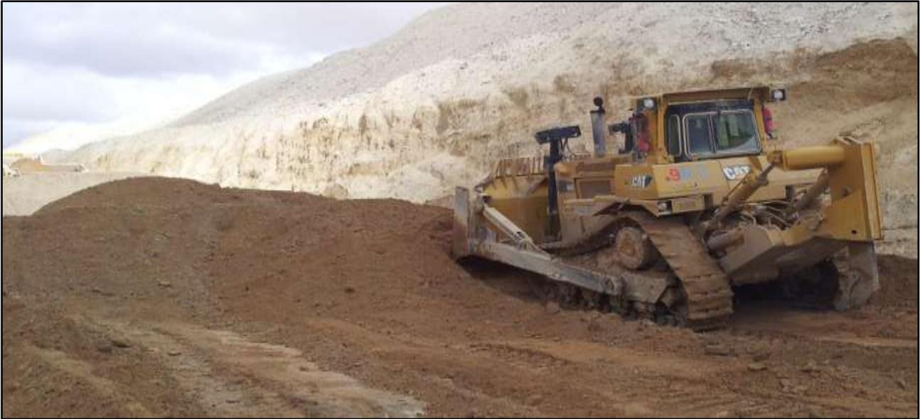
*Fig. 12 : Gerbage par BULLSD9 (capacité du godet 5m<sup>3</sup>)*
