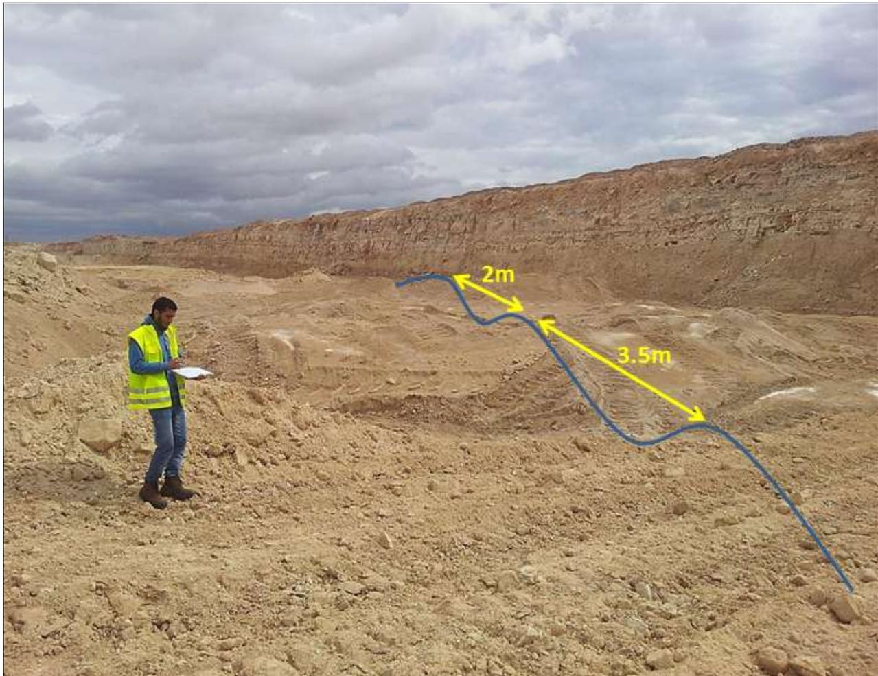
*Fig. 20 : Ondulations au niveau du mur de la couche 2 du panneau 5*
