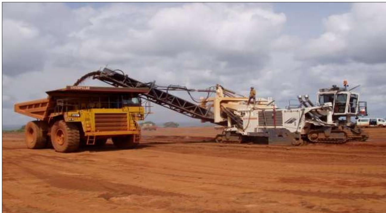
*Fig.42 : Surface Miner 2500 en cours de chargement*
