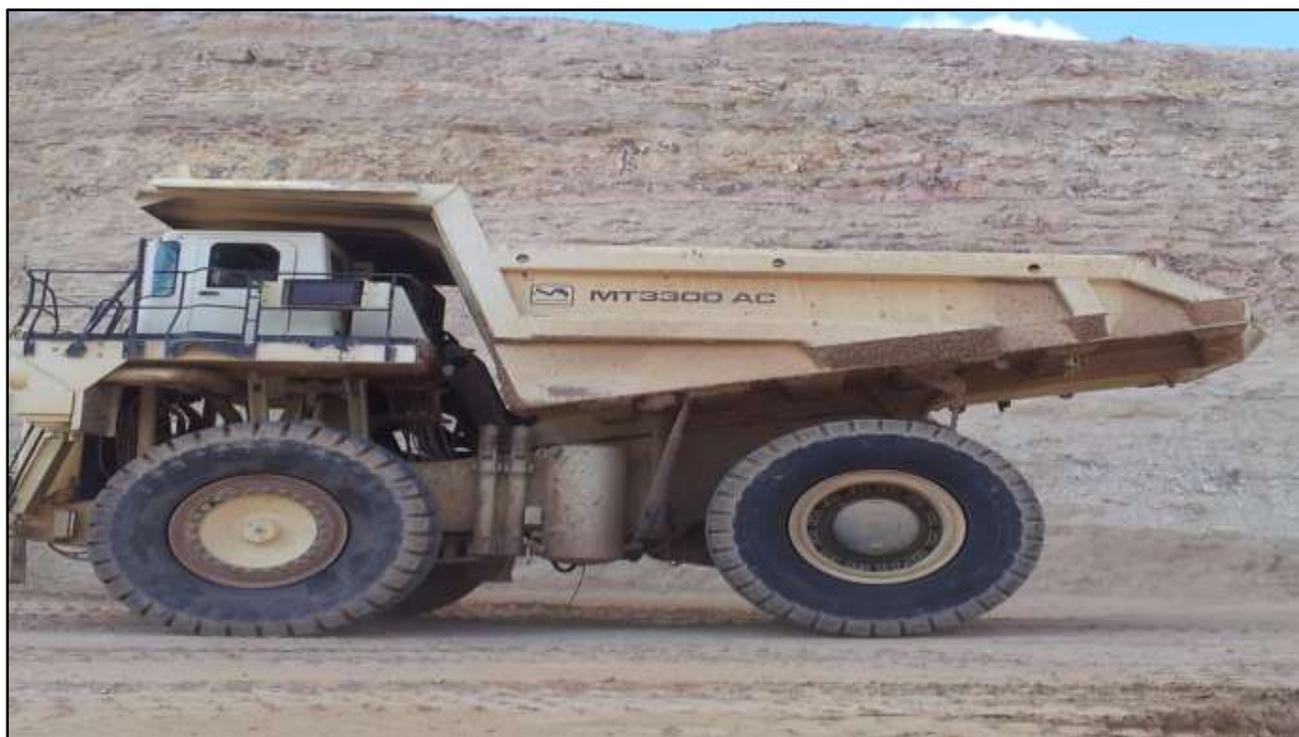
*Fig. 15 : Camion de type TEREX MT3300 AC (capacité 136 t)*
