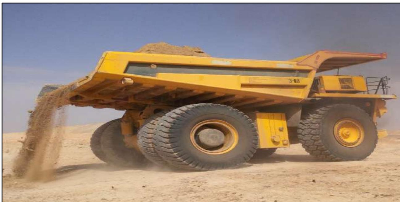
Fig. 41 : Perte liée au débordement du camion (capacité 170 t)
