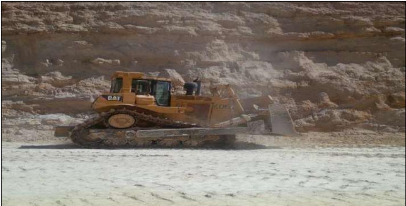
*Fig. 39 : nettoyage par Bull D9 (capacité du godet 5m<sup>3</sup>)*
