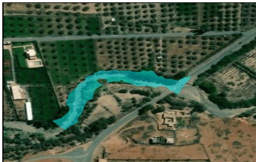
Figure 22 : étendue de la crue qui correspond à une période de retour de 10 ans
